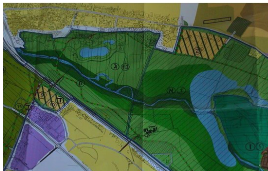
תרשים 16: תשריט תמ"מ 5/6 נחל אילון - סימון הפיתולים שיושרו בתכנית המתאר המחוזית חלקית לנחל אילון ומתן הוראה לשמירתם והשבתם
